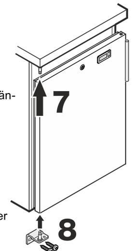
7. Tür wieder in Scharnierbolzen einhängen und schließen.
