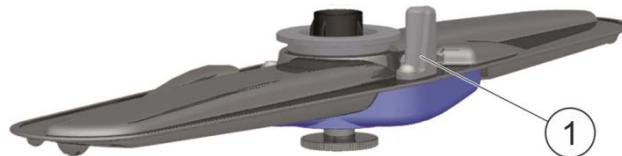
5. Damit der Sensor die Drehung des Spü larmes erkennt, alle Schmutzpartikel und eisenhaltige Partikel, die am Magneten (1) haften, entfernen.
