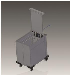
Les ressorts sont placés derrière le dispositif de protection de séparation (capotage des ressorts). Pour les distributeurs chauffants, la position des ressorts par rapport à la poignée de sécurité ou au panneau de commande est différente de celle illustrée.
