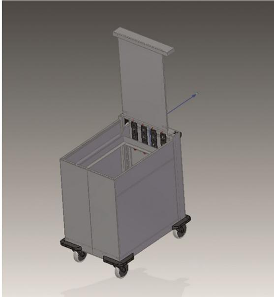
Après avoir retiré le dispositif de protection isolant (couvercle de ressort), il est possible d'accéder à la zone des ressorts de traction attachables et détachables.
