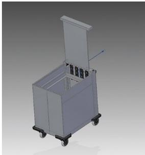
Hinter der Trennenden Schutzeinrichtung (Federabdeckung) befinden sich die Federn. Bei heizbarem Stapler ist anders als im Bild die Lage der Federn gegenüber dem Sicherheitsschiebegriff bzw. Bedienfeld.
