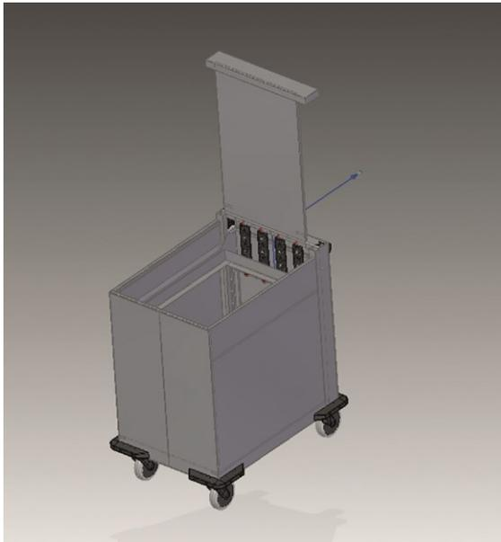
Dopo aver rimosso l'elemento divisore di protezione (coperchio a molla) si raggiunge l'area delle molle di trazione sganciabili.
