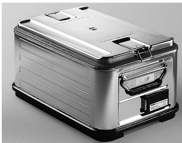
TP 105 L verwarmbaar – oppervlakverwarming in het corpus in het bodemgedeelte en circa 2/3 hoogte aan de zijkant
