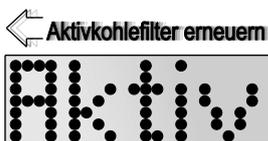
Les filtres à charbon actif Rieber doivent au plus tard être remplacés à des intervalles de 500 heures de service. En règle générale, vous devez obligatoirement utiliser le type de filtre affiché.
