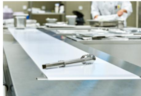
Im Zentrum der neuen Küche ist das Speiseverteilssystem der Rieber ag mit gleich zwei Speiseverteilbändern: Das längere ist fix installiert, während das kurze flexibel beiseitegeschoben werden kann.
