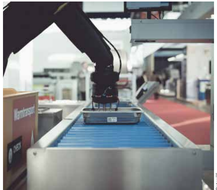
Die analogen und digitalen Konzepte von Rieber und Check Cloud vereinigen sich in der Speisenproduktion und -logistik auch mit Robotertechnologie. Am Portionierband wird abschließend der GN-Behälter und der QR-Code mit Check Cloud „verbunden“.
