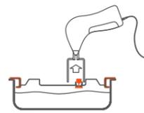
vaculid® auf Behälter stecken, Pumpenaufsatz auf Ventil setzen.
