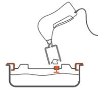
Pumpe betätigen, Vakuum im Behälter entsteht.
